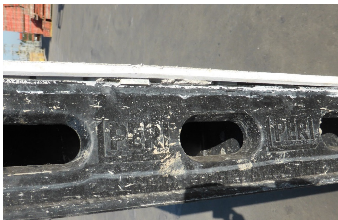
29.25 Beton szennyezés, hiányzó csavarok miatt
