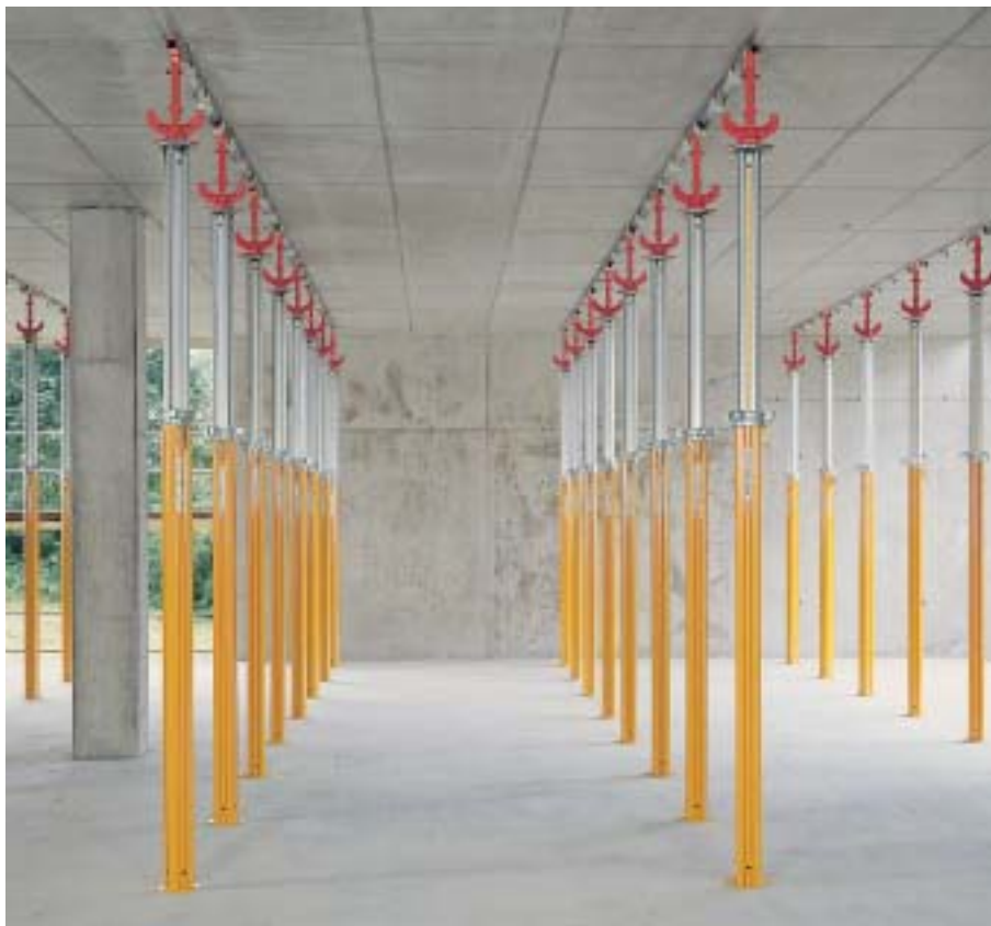
MULTIPROP 350 és SKYDECK födémzsalu kizsaluzott állapotban. 40 cm-es födémvastagságig mindössze 0,29 támasz/m 2 elegendő.
